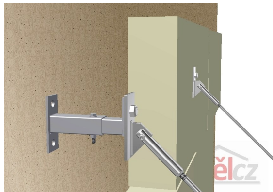
Kotvící konzole č3 do zateplené fasády
