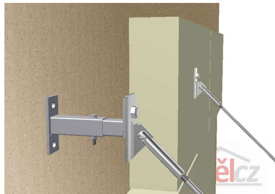
Kotvící konzole č3 do zateplené fasády
